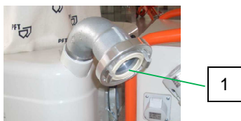
Рис. 15: Присоединение подающего рукава
