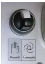
Рис. 8: Режимы работы воздушного компрессора
