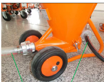
Рис. 15: Присоединение подающего рукава
