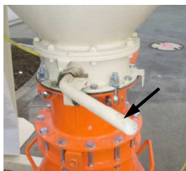
Рис. 33: Закрытие выпускной заслонки хранилища
