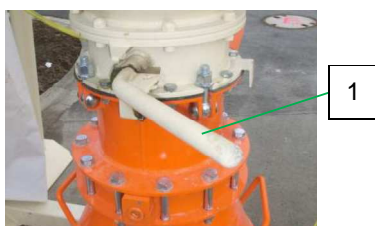
Рис. 40: Закрытие выпускной заслонки хранилища
